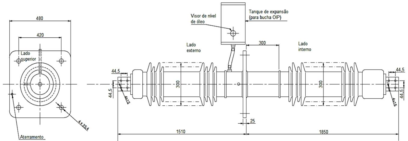
Figura 1 – Bucha de Passagem 145 kV – Montagem Horizontal
